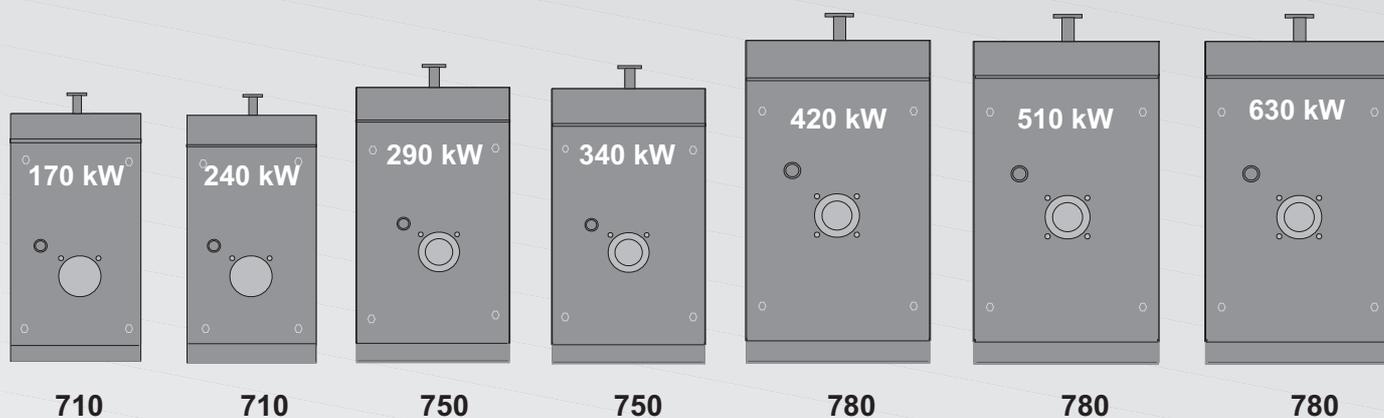
Размеры котлов по ширине без теплоизоляции (в мм).
