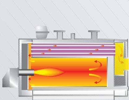
Данная система определяет охлаждение конструктивных элементов котла и уменьшает образование кальциевых отложений во внутренней его части. Овальная форма обечайки предохраняет «жизненно важные» части агрегата от наслоения шлама, присутствующего в установке, и обеспечивает, таким образом, достаточный зазор между топкой и самой обечайкой.
