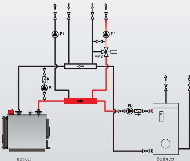
На данном рисунке представлена типовая схема установки, снабженной бойлером для производства воды для бытовых нужд, состоящая из двух отопительных контуров, один из которых управляется при помощи смесительного клапана с электроприводом.
